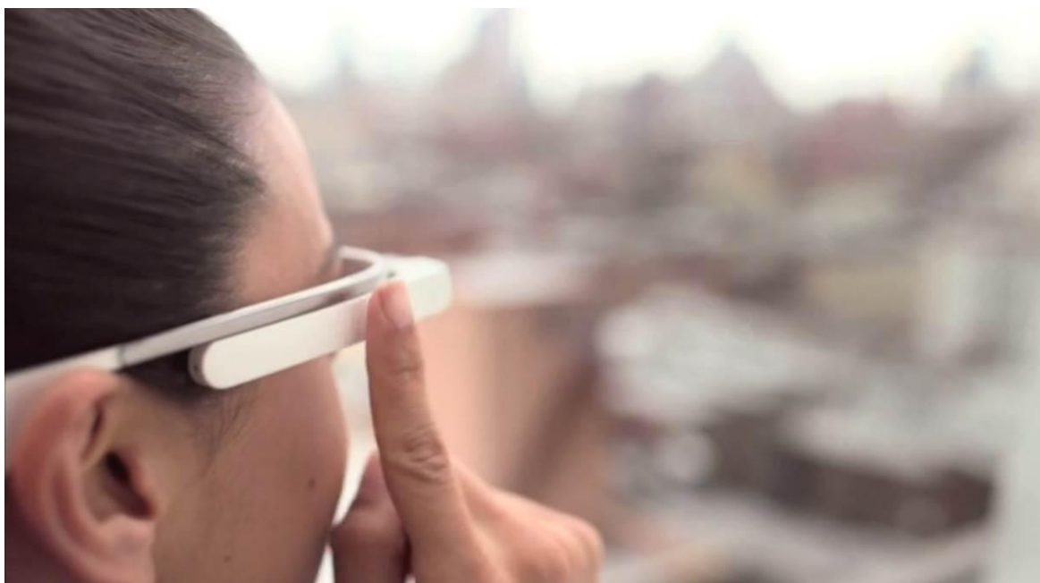
Figura 18b: Google Project Glass - Touchpad. Fonte: Reprodução do vídeo "Glass How-To: Getting Started". Disponível em: http://www.youtube.com/watch?v=4EvNxWhskf8 . Acesso em 14 abr. 2013.
