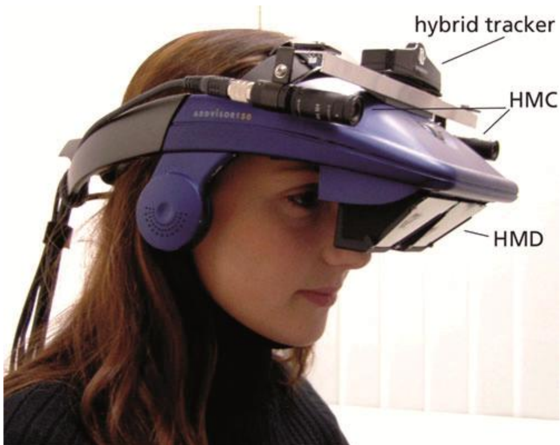
Figura 8a: Capacete HMD (head-mounted display) com visão estereoscópica. Fonte: Jvrb.org. Disponível em: http://www.jvrb.org/past-issues/1.2004/34 . Acesso em 23 mar. 2013
