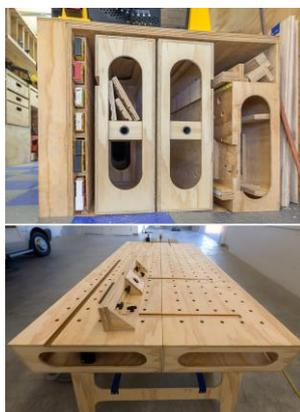
**Figura 15 - As duas peças que formam o tampo e bancada desmontadas e bancada montada após união dos mesmos.**
