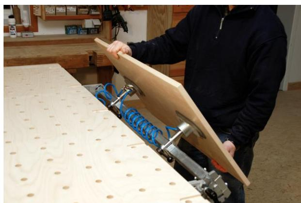
**Figura 13 - O módulo de vácuo MT pode ser facilmente montado em todas as bancadas Einemann ou bancadas de trabalho existentes. Ao combinar isso com a bancada de altura regulável a peça de trabalho fixada pode ser posicionada sem esforço e sem o contratempo da fixação dos grampos convencionais.**
