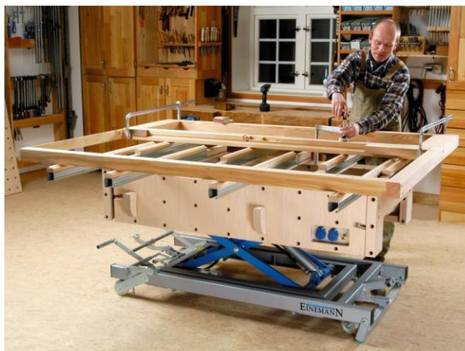
**Figura 12 - Fixação de peça em produção na superfície da bancada; fixação feita com o auxílio de grampos convencionais.**
