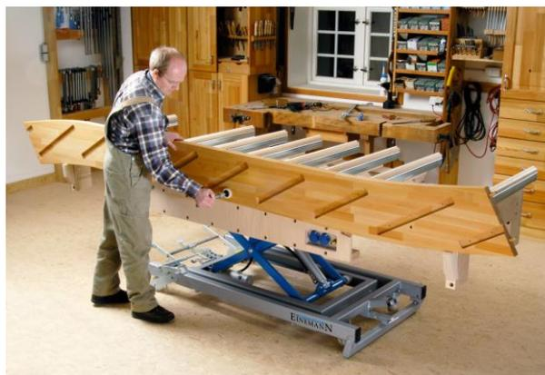
**Figura 11 - Bancada Einemann em uso; fixação da peça a ser trabalhada feita por grampos convencionais na lateral, exemplo de uso de acessórios externos acoplados a suportes na bancada.**
