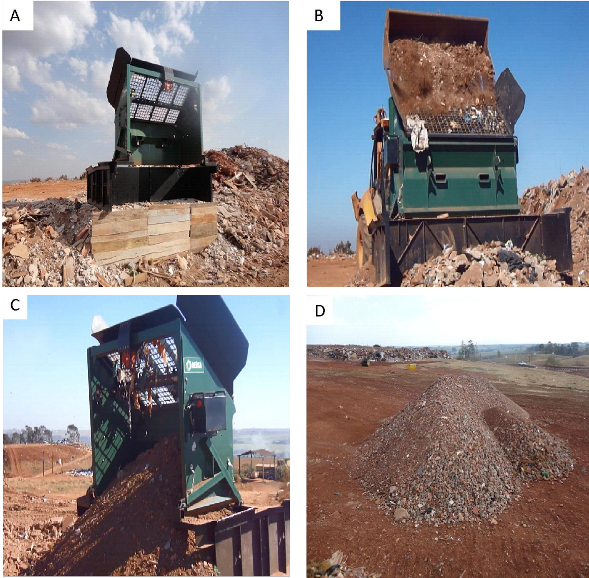
Figura 7. Peneira vibratória. (A) Peneira, (B) Retroescavadeira alimentando a peneira, (C) Pós peneiração (D) Material britado. Jaboticabal, SP, 2015.
