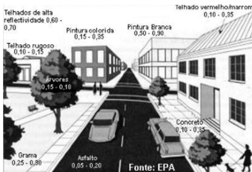
Figura 2 - Albedos de Materiais Urbanos
