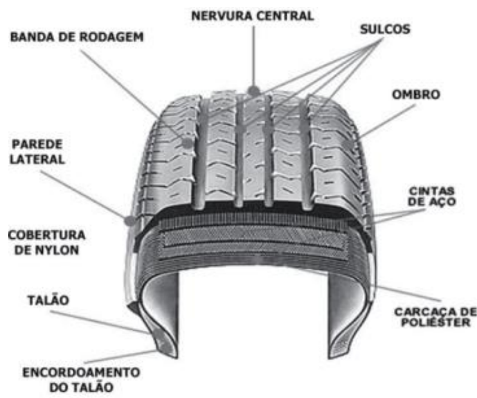
Figura 2. Estrutura do pneu.
