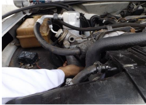
Figura 10 - Retira do Filtro Para Fazer Limpeza
