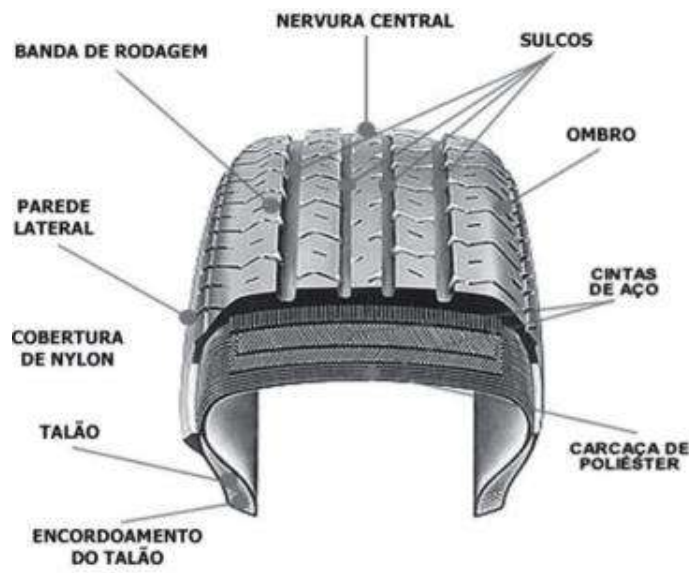
Figura 2. Estrutura do pneu.
