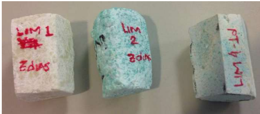
Figura 4 . Caseína produzida com o uso do suco de limão e amostras de caseína solidificada.
