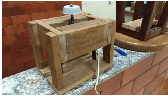
Figura 5. Motor do ventilador e invólucro de madeira.
