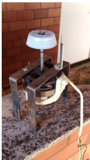
Figura 4. Motor do ventilador utilizado adaptado à base de meta.
