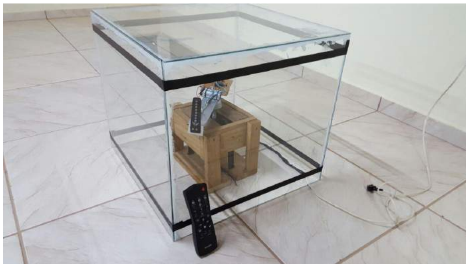
Figura 15. Sistema do display rotativo com o controle remoto para ajuste, caixa de proteção de vidro, invólucro de madeira e hélice com o circuito eletrônico
