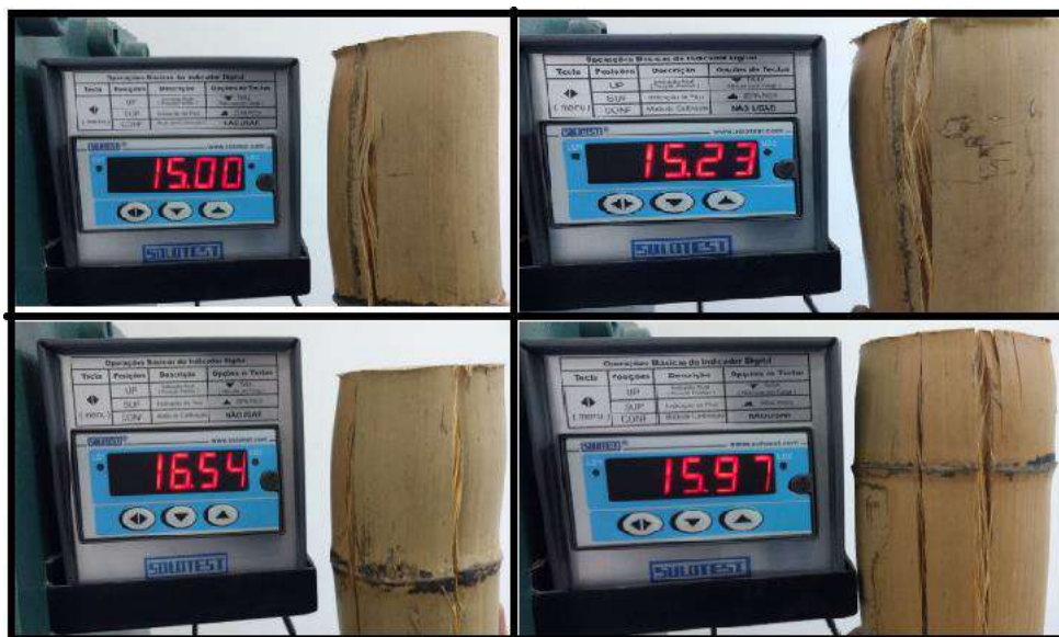
Figura 4. Ensaio de compressão no bambu e seus respectivos resultados em toneladas.
