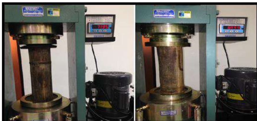
Figura 12. Terceiro e quarto teste de compressão axial.
