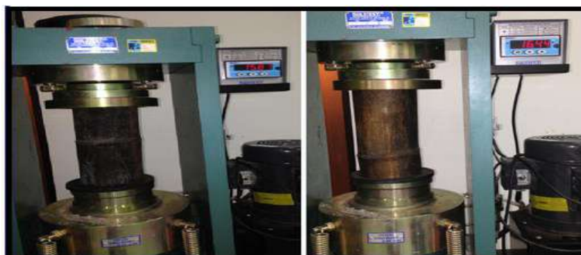
Figura 10. Terceiro e quarto teste de compressão axial.
