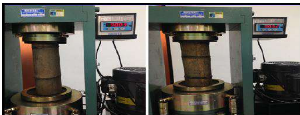
Figura 13. Primeiro e segundo teste de compressão axial.
