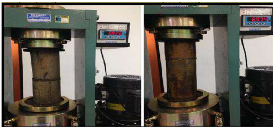
Figura 11. Primeiro e segundo teste de compressão axial.
