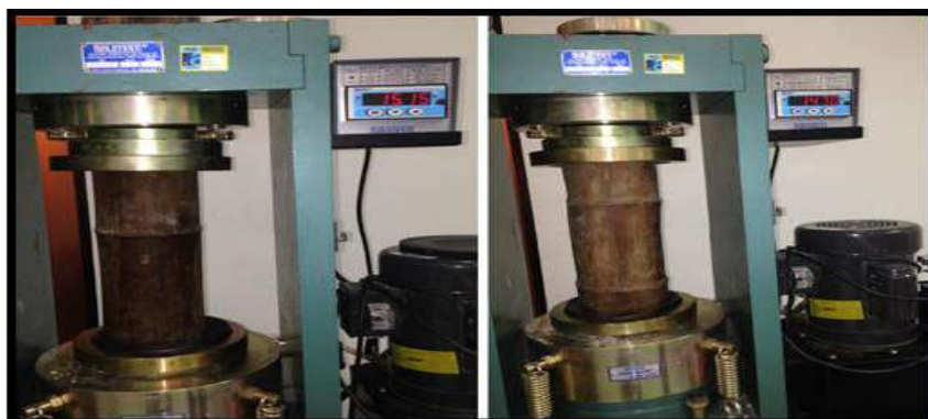
Figura 9. Primeiro e segundo teste de compressão axial.
