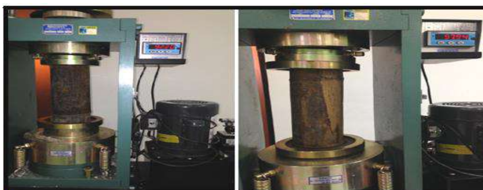
Figura 14. Terceiro e quarto teste de compressão axial.
