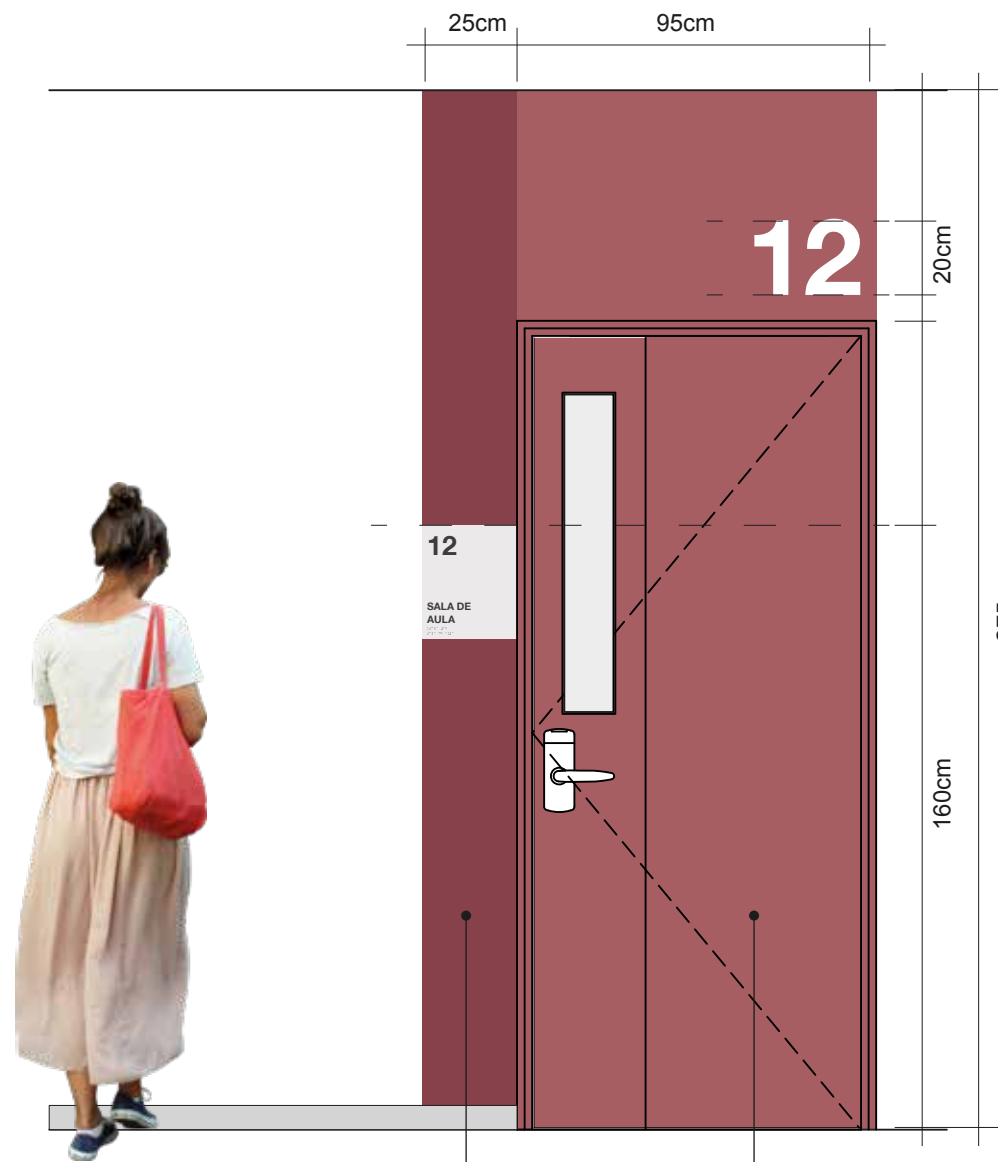
ELEVAÇÃO PORTA SALA ESC.: 1:20 Parede pintada nas cores do andar Porta adesivada. nas cores do andar
