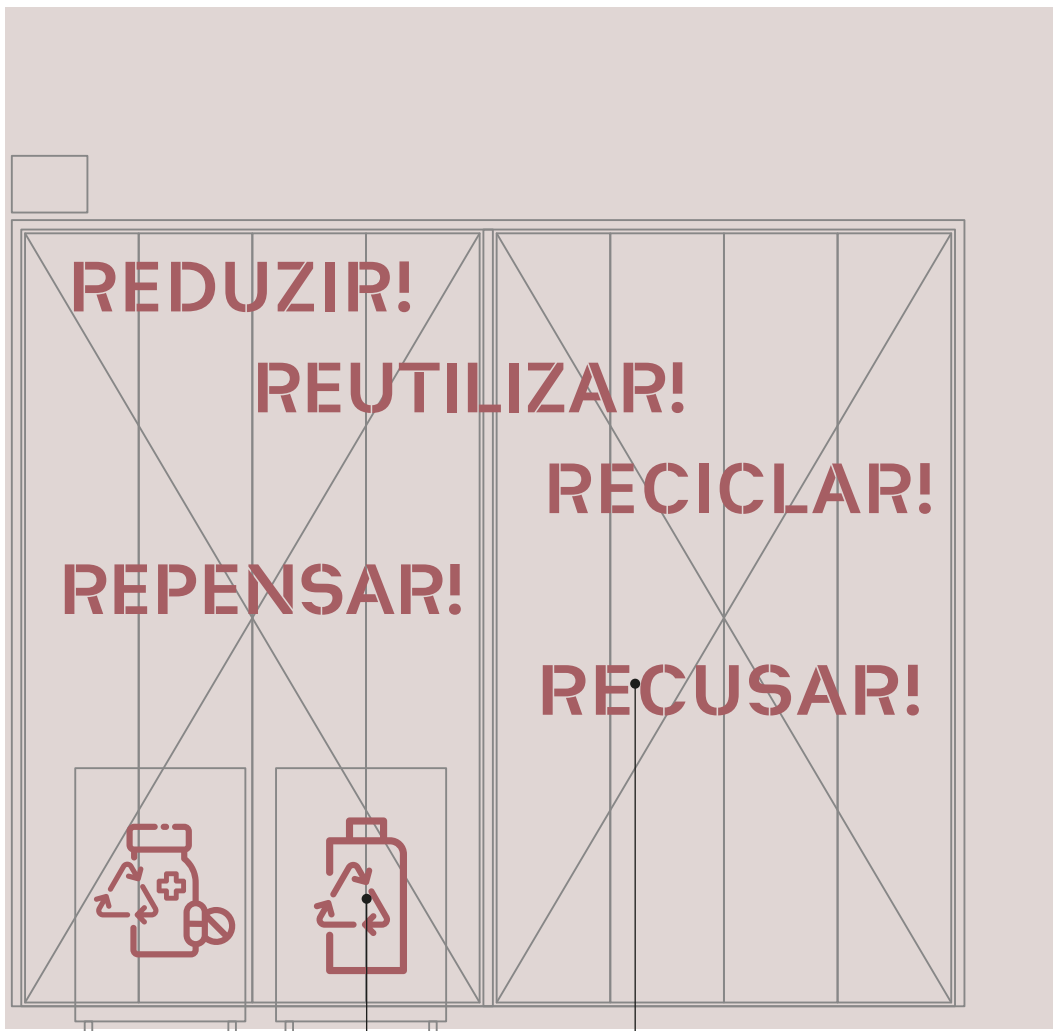
A7 ELEVÇÃO 1º ANDAR ESC.: 1:20 Pictogramas de reciclagem a definir Pictogramas e textos aplicados em película vinílica adesiva diretamente nas paredes
