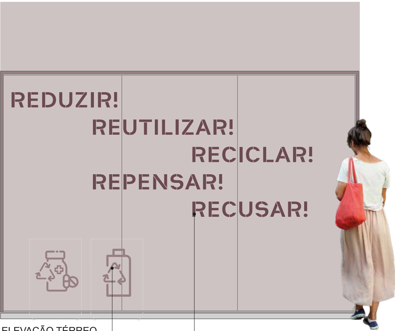
A5 ELEVÇÃO TÉRREO ESC.: 1:20 Pictogramas de reciclagem a definir Pictogramas e textos aplicados em película vinílica adesiva diretamente nas paredes
